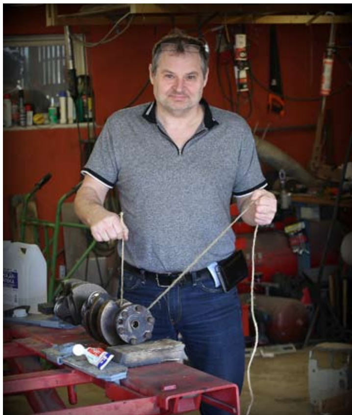
Jonas slipar en vevaxel med hjälp av tandkräm och ett snöre. Foto: Lennart A.
