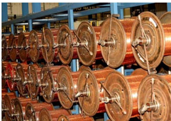
Rullar med koppartråd som ska tvinnas ihop till en grov kabel.
