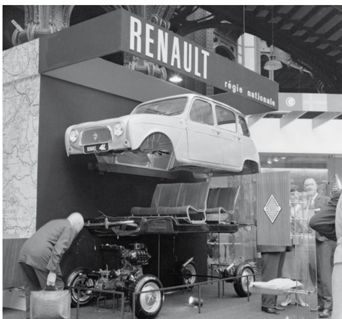
Renault 4 var tillverkarens första framhjulsdreven modell, dessutom hade den inte självbärande kaross utan den var fastbultad i bottenplattan. Det tog inte lång tid förrän mistänksamma blickar byttes mot dyrkan.
