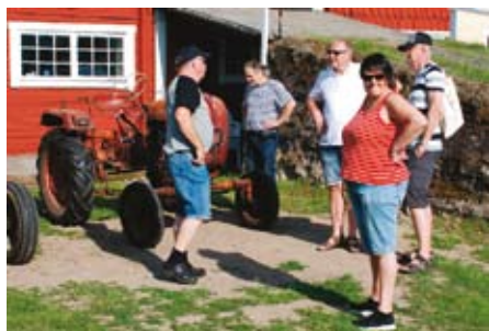
Siwert Axelssons senaste förvärv en Allgaier A 111 från 1953 drog till sig många blickar. De här traktorerna såldes också som Porsche och drivs fram av en luftkyld diesel på tolv hästkrafter.
